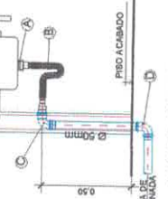
DETALHE EXECUTIVO DE ESGOTO RAMAL DA PIA DE COZINHA ESC. 1/16
